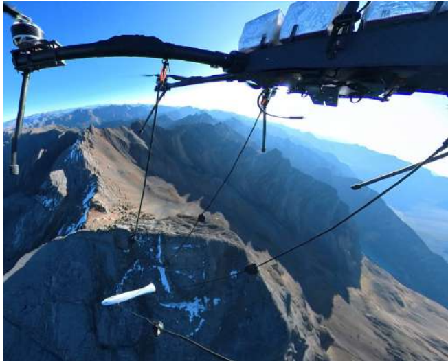
FOTOGRAMETRÍA CORDILLERA DE LOS ANDES PERÚ . Vuelos de drone con altitud de hasta 5,500 m s.n.m. siguiendo el contorno de la superficie con GSD de 7 cm. Sección de 5,000 has - Ascensos de hasta 1,000 metros y recorridos de hasta 12 Km . Ver video 71
